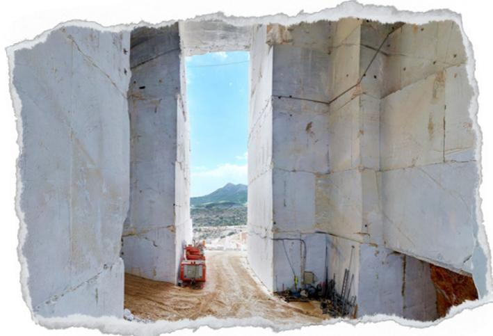
為實現此目標，公司在1999年至2001年期間參與了歐盟為期三年的研究計劃。與歐盟國家的學術機構和礦業行業合作，開發了地下大理石開採的整合規劃和方案。開採方法是採用房柱式法，開口部分最多達到15米寬，而挖掘物的最大高度為30米。同時在與 NTUA 矿業工程學院的合作研究和模擬後，實施預防性支撐措施（錨）。
